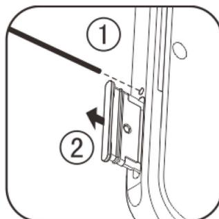
2. Kovovou plochu nano karty (SIM1 / SIM2) nebo micro SD karty otočte směrem dolů tak, aby šikmý úhel odpovídal úhlu v přihrádce pro karty. Vložte nano kartu (SIM1 / SIM2) nebo micro SD do otvoru pro kartu podle směru vyznačeného šipkami na obrázku.
