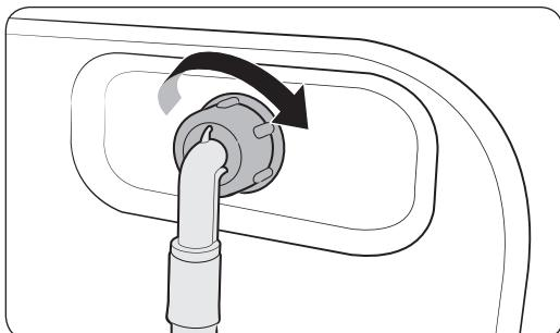
8. Druhú stranu hadice na vodu pripojte k prívodovému ventilu na zadnej strane práčky. Hadicu dotiahnite otočením v smere hodinových ručičiek.
