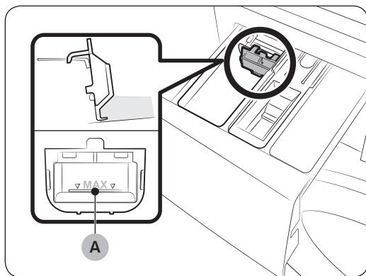
Nejprve do **II** příhrádky pro hlavní praní vložte dodanou přepážku na tekutý prací prostředek. Poté do přepážky nalije po maximální rysku (A) tekutý prací prostředek.
