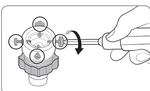
2. Pomocí křížového šroubováku uvolněte čtyři šrouby na adaptéru.
