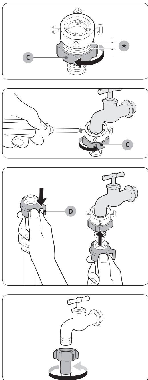
3. Přidržte adaptér a uvolněte součást (C) otáčením ve směru o 5 mm (\*).
