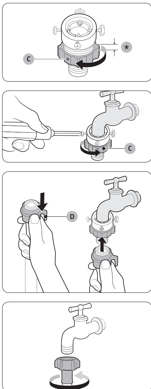
3. Držte adaptér a otáčajte dielom (C) v smere šípky a uvoľnite ho o 5 mm (\*).
