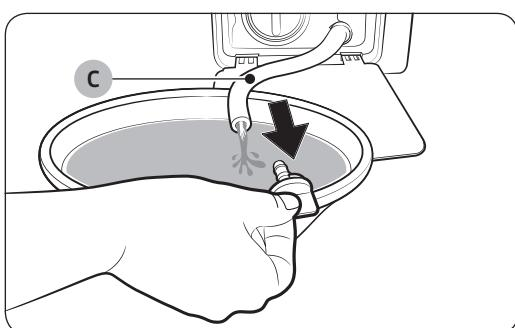
4. Odstráňte uzáver z trubice núdzového vývodu (C) a vodu z nej nechajte vytieciť do nádoby.
