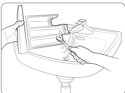
3. Součásti zásuvky vyčistěte pod tekoucí vodou pomocí měkkého kartáčku.
