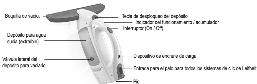
Imagen 2: elementos de control del aspirador de ventanas
