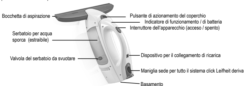
Figura 2: Dispositivi di comando del puliscivetri
