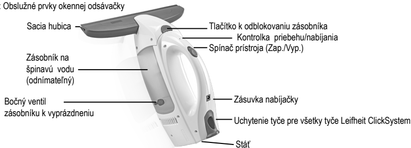
Obrázok 2: Obslužné prvky okennej odsávačky
