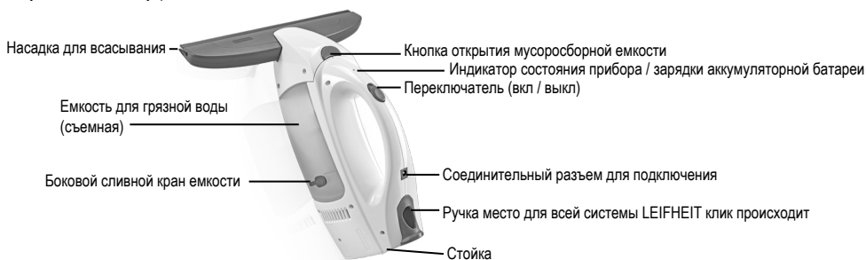
Рисунок 2: Элементы управления оконным пылесосом
