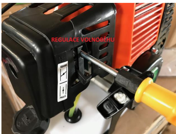
(1): Nastavovací šroub volnoběžných otáček (křížový šroub)
