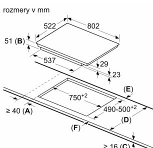
A: Minimálna vzdialenosť od výrezu na varnú dosku k stene.
