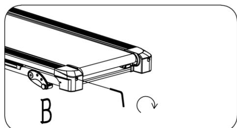
Bežecký pás sa priebehom času uvoľní. Aby ste ho znova utiahli, pootočte oboma nastavovacími skrutkami o celú otáčku v smere hodinových ručičiek. Skontrolujte napnutie pásu. Tento postup opakujte, kym nebude pás riadne napnutý. Dávajte si pozor, aby ste obe skrutky utiahli rovnakou mierou. Riadte sa podľa obrázka C.
