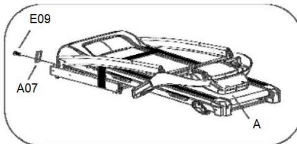
Odstráňte skrutku M8x15 (E09) a bezpečnostný blok (A07) pomocou imbusového kľúča (B07).
