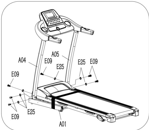
Pomocou imbusového kľúča (B08) a skrutiek M8x15 (E09) s poistnými podložkami (E25) upevnite stípk'y (A04, A05) k základni (A01).
