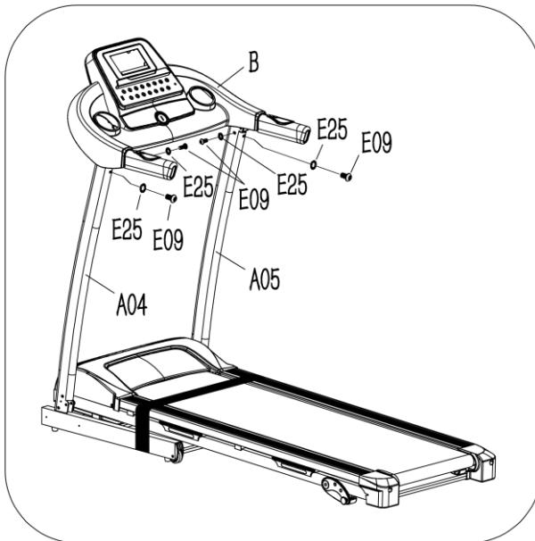
Pomocou imbusového kľúča (B08) a skrutiek M8x15 (E09) s poistnými podložkami (E25) pripojte ovládací panel (B) k stípkom (A04, A05).
