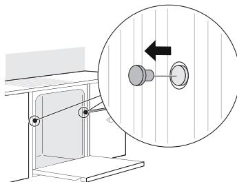
**2** Zavŕťte skrutku do dreva ( $\Phi 4,5 \times 12$  mm) cez montážnu konzolu a do rámu skrinky.
