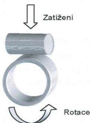
Obr. 1: Schéma třecího kontaktu Reichertova testu
