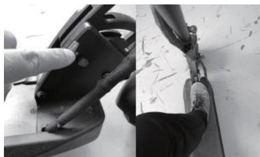
Krok 6: Odomknite ochranný kolík. Sklopte páčku a zatlačte riadidlá dopredu, aby ste kolobežku zložili.
