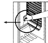
Veuillez à ce que le canal et le trou d'écoulement ne soient pas bouchés afin que l'eau produite dans la chambre froide puisse toujours s'écouler librement.
