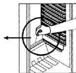
Se till att avloppsrännan och avloppsöppningen inte är blockerade så att vattnet som produceras i kylskåpet alltid kan rinna av fritt.
