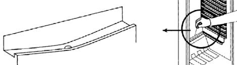
Assicurarsi che il pozzetto di scarico e il foro di scarico non siano in alcun modo ostruiti, in modo da garantire un deflusso continuo e corretto dell'acqua prodotta nel frigorifero.
