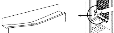
Upewnić się, że kanał ściekowy i otwór spustowy nie są zablokowane, aby woda kondensowana w lodówce mogła zawsze odpływać bez przeszkód.
