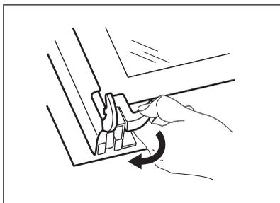
8. Uvoľnite blokovací systém, aby sa dal vybrať vnútorný sklenený panel.
