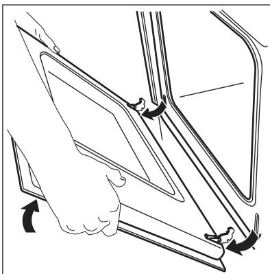
6. Přivírete dvířka trouby do první polohy otevření (do poloviny). Pak dvířka vytáhněte směrem dopředu z jejich umístění.
