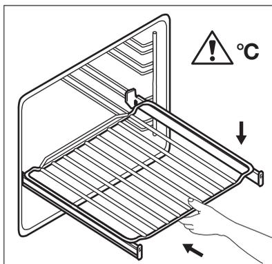
2. Na teleskopické výsuvy položte drátěný rošt a opatrně je zasuňte do spotřebiče. Před tím, než zavřete dvířka trouby, se ujistěte, že jste teleskopické výsuvy zcela zasuňuli do spotřebiče.
