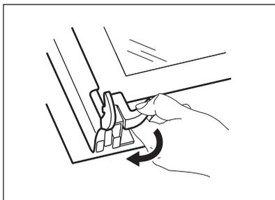
8. Uvolněte blokovací systém a vytáhněte vnitřní skleněný panel.
