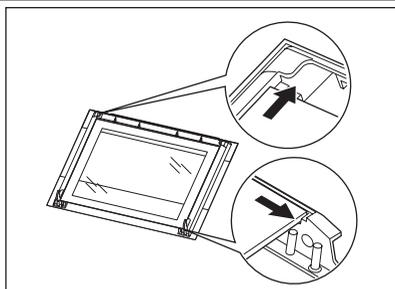
Po vyčištění skleněný panel a dvířka trouby opět nasadíte. Provedte výše uvedené kroky v opačném pořadí.
