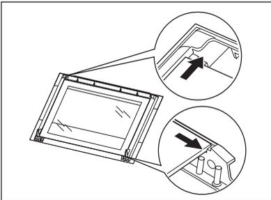
Po ukončení čistenia namontujte sklenený panel a dvierka rúry. Pri montáži zvolte opačný postup. Povrch s potlačou musí smerovať do vnútra dvierok. Po inštalácii skontrolujte, či nie je povrch skleneného panela na mieste potlačače na dotyk drsný. Uistite sa, že ste vnútorný sklenený panel namontovali do lôžok správne. Pozrite si uvedený obrázok.
