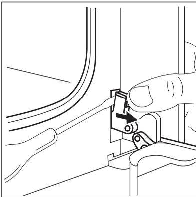
3. Jednou rukou podržte zatlačený prvok. Druhou rukou uchopte skrutkovač a použite ho na nadvihnutie a otočenie príchytky praveho závěsu.
